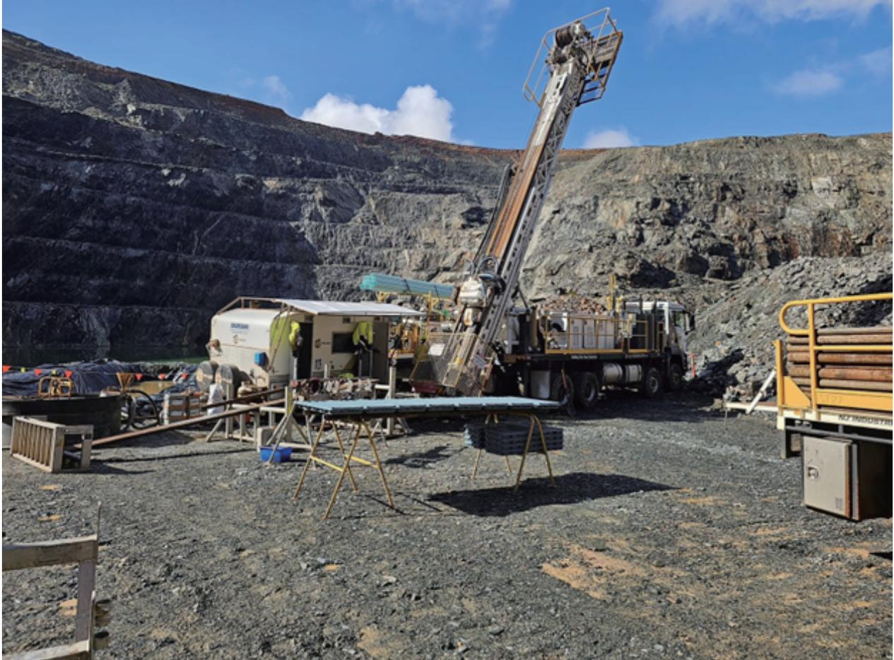
圖6，為岩土勘察在Copperhead開啟金剛石鑽探計劃。
