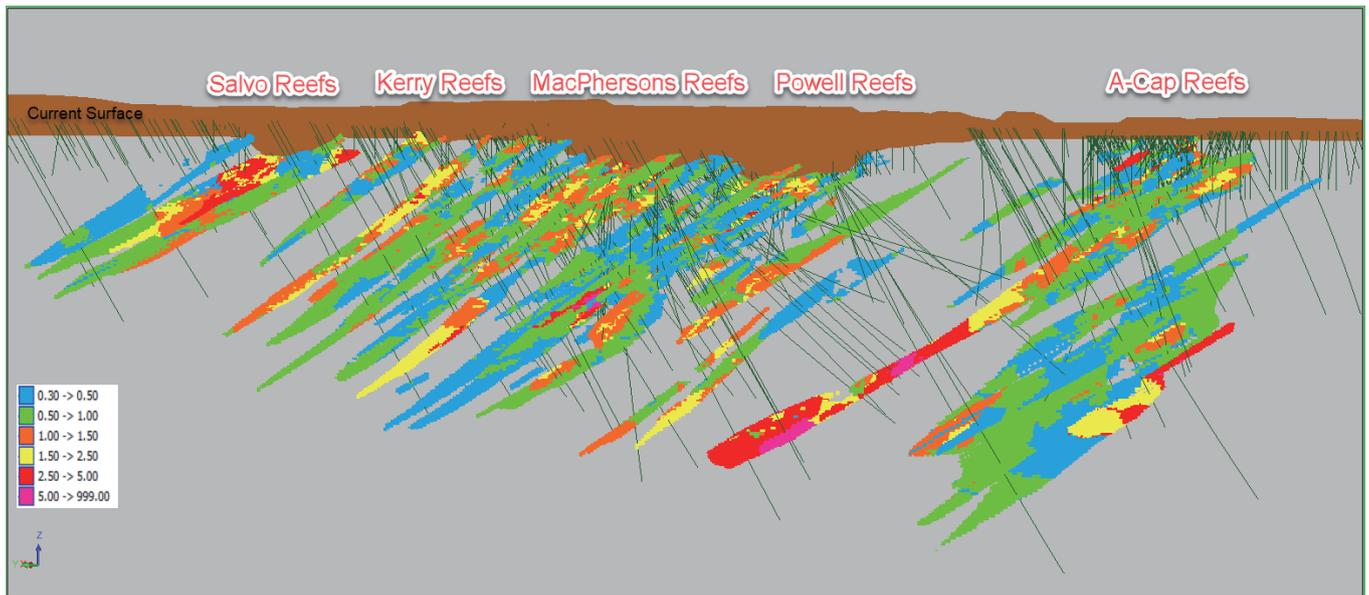
圖3：MacPhersons Rewards礦床，看向東南方向，顯示模型資源，鑽孔及以前採坑
