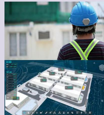
集團研發工人實時監控系統，在安全帽上裝設感應器，利用藍牙技術，實時監測並自動記錄工人在工地各區的分佈與停留時間，協助管理、分析和調動現場工人，匯報工作表現。在疫情高峰期間，同時用作監控工地各區的工人人數，避免過多工人聚集施工，控制感染風險；萬一有工人確診，亦可協助追蹤其密切接觸者，隔離相關人員及重點消毒工作區域。
