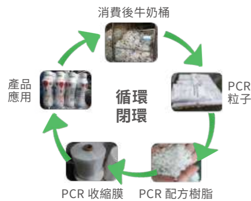
PCR 包裹膜回收再生系統圖
