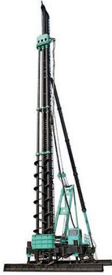
SMW工法樁機
