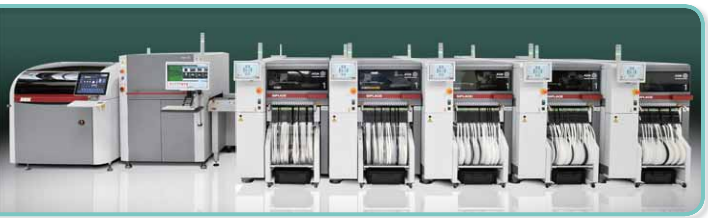
集團已於SMT生產中引入具備印刷、錫膏檢測及配置機的閉環式解決方案
