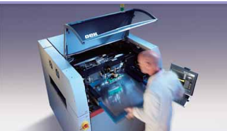
DEK NeoHorizon印刷機為高度組合式的設計，客戶需要時，可使兩台設備合二為一，提供一個高度靈活的雙軌平台
