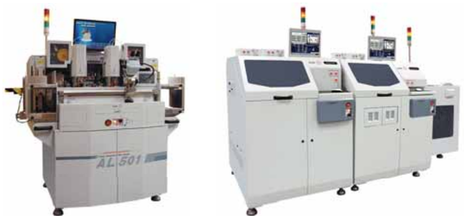
ASM為電源電子市場提供的解決方案－粗鋁線焊接機及eClip。
