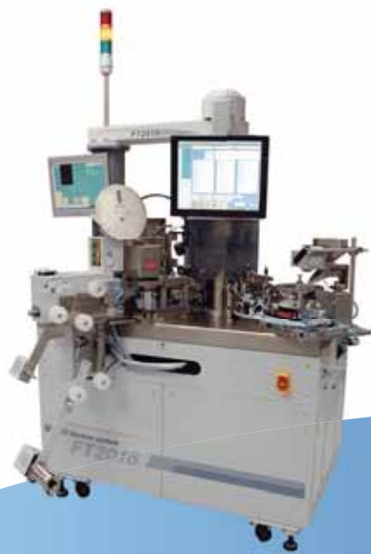
FT2018測試處理機應用於集成電路及離散器件包裝。
