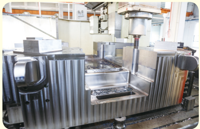
一件大型非標模架正進行加工
