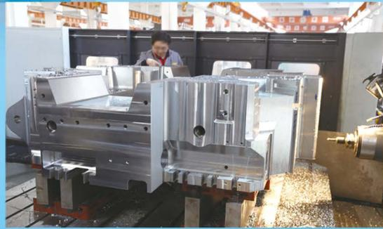
用作加工汽車注塑件模具的五軸加工中心。
