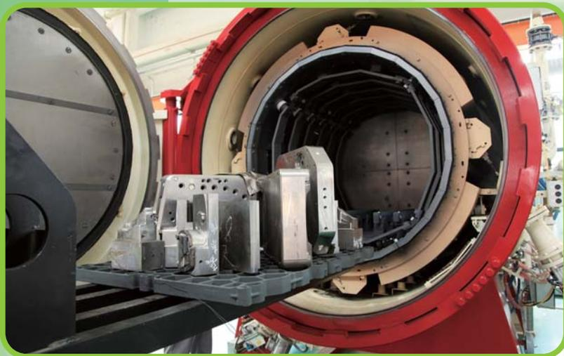
位於中國杭州廠的熱處理車間，擁有不同容量的先進真空熱處理爐，為生產壓鑄模具及工程塑料所用硬模之客戶提供高效服務。
