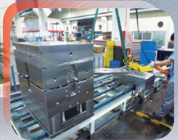
▼ 將精密模板組裝成整套模架。 Assembly of mould base set from precision plates.
